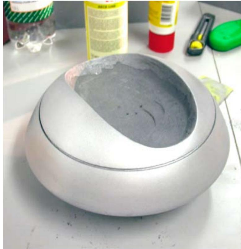
Der Sockel des Heizlüfters und der Luftbefeuchter konnten beide in einem Arbeitsgang eingefärbt werden. Der Sockel wurde zusätzlich mit mattem Klarlack überzogen damit das Metallic-Finish nicht abfärbt.
