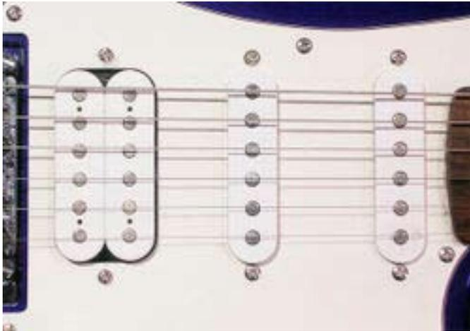
Für E-Gitarren gibt es nur ein verbreitetes Pickup (Tonabnehmer) system. Dies sind Elektromagnetische Pickups. Das Prinzip ist sehr simpel: Eine Spule mit einem Magnetkern wird unter den Stahlsaiten der Gitarre angebracht. Die Schwingungen der Saiten (also wenn die Saiten angeschlagen werden) erzeugen eine Spannung in der Spule (elektromagnetische Induktion). Dieser sehr schwache Strom kann dann Verstärkt werden und über einen Lautsprecher hörbar gemacht werden.
