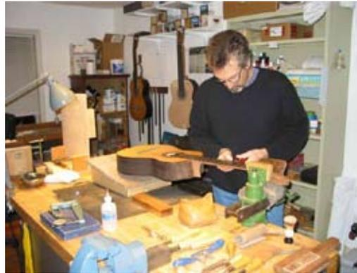
Das Bundieren ist die wohl heikelste Sache am ganzen Gitarrenbau. Vor allem die Vorarbeit muss sehr genau durchgeführt werden um nachher ein funktionstüchtiges Griffbrett zu erhalten. Ein nur minim falschplatzierter Bund bedeutet die Unbrauchbarkeit des Griffbrettes. Es ist also essentiell, dass die Bundabstände genau stimmen.
